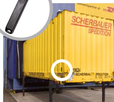
Auch die Wechselbrücken haben einen Transponder erhalten.
