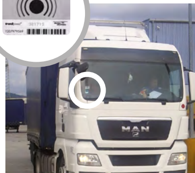
Die Scheibentransponder kommunizieren mit dem Leser.
